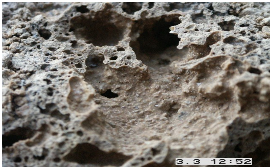
Ryc. 20 Zdjęcie mikroskopowe materiału- Atonit produkt po obróbce termicznej w reaktorze mikrofalowych w technologii MTT[10]
