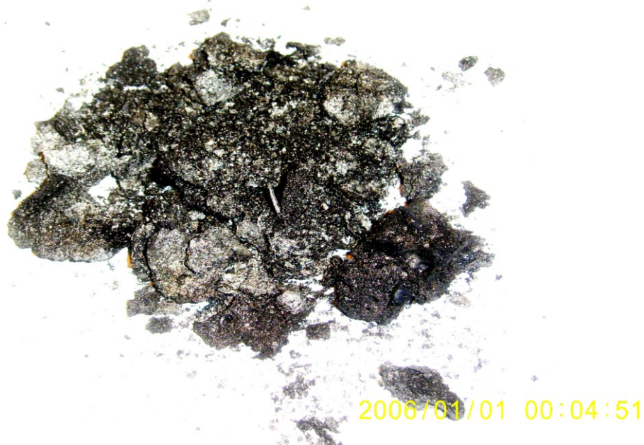
Ryc. 41 Karbonizat pochodzący z odpadów organicznych produkowanych przez ubojnię drobiu – widoczne składniki mineralno – organiczne( tlenki)
