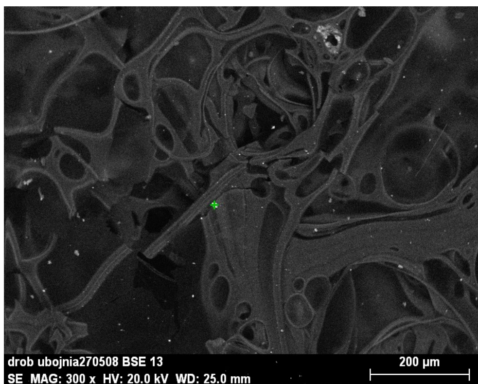
Ryc. 45 Wybrany i zaznaczony punkt miejsca dokonania analizy metodą EDX [13]
