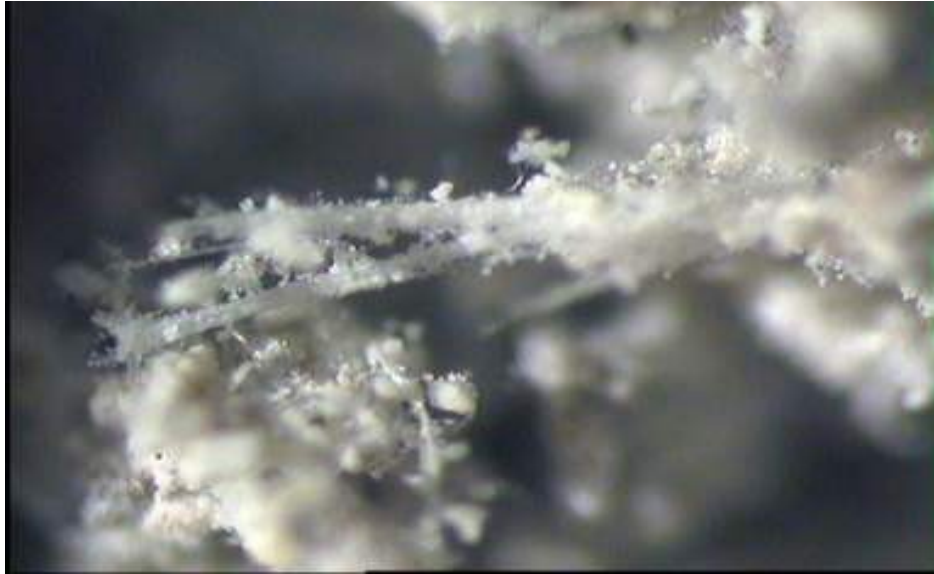
Ryc. 17 Zdjęcie mikroskopowe materiału zawierającego azbest – widoczna struktura rakotwórczych włókien – zdjęcia [10]
