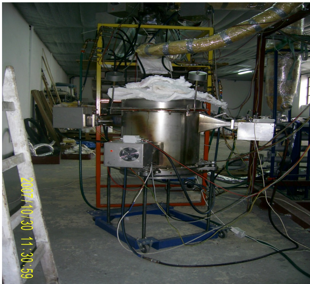
Ryc. 24 ATON 20 – podczas prób karbonizacji odpadów mineralno – organicznych pochodzących z ubojni drobiu
