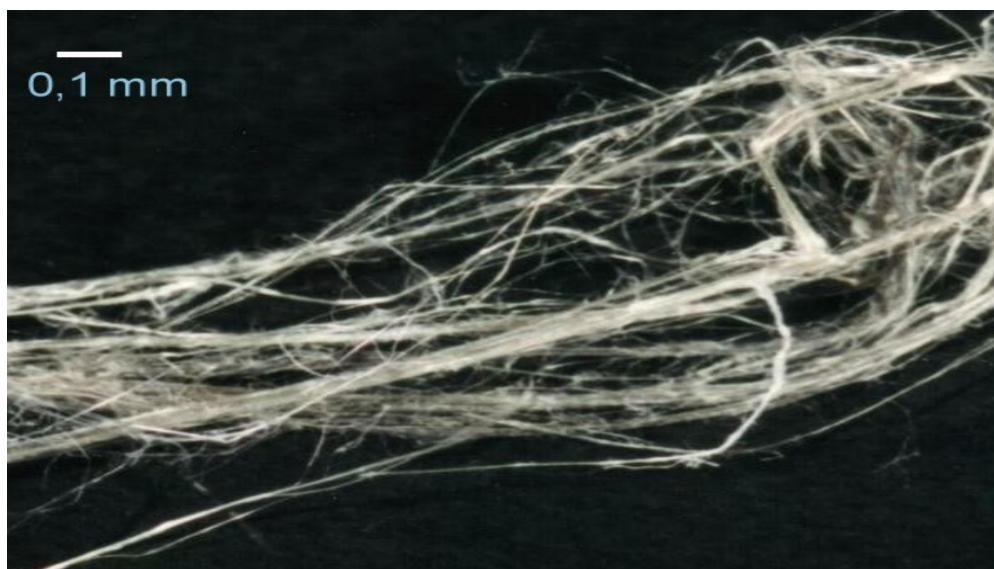
Ryc. 16 Zdjęcie mikroskopowe materiału zawierającego azbest – widoczna struktura rakotwórczych włókien – zdjęcia [10]
